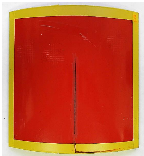
Detail mřížkové zkoušky dle ČSN EN ISO 2409
