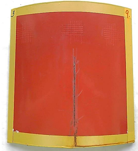
Detail mřížkové zkoušky dle ČSN EN ISO 2409
