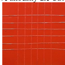
Detail mřížkové zkoušky dle ČSN EN ISO 2409
