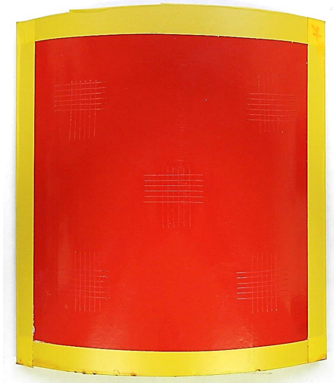
Detail mřížkové zkoušky dle ČSN EN ISO 2409
