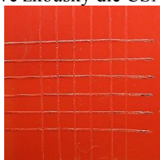
Detail mřížkové zkoušky dle ČSN EN ISO 2409
