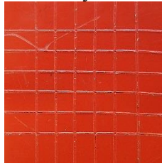
Detail mřížkové zkoušky dle ČSN EN ISO 2409
